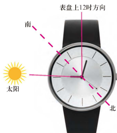
图 1-9 利用手表定方位示意图
