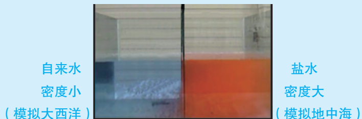
图4-2-3 密度流模拟实验
