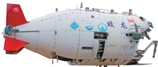
图3-20 我国“蛟龙”号载人潜水器最关键的部件——供人活动的耐压球壳是用钛合金制造的
