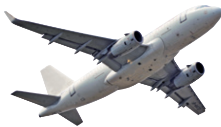
图3-18 硬铝常用于制造飞机的外壳
