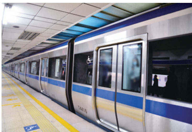
图3-15 用不锈钢制造的地铁列车的车体
