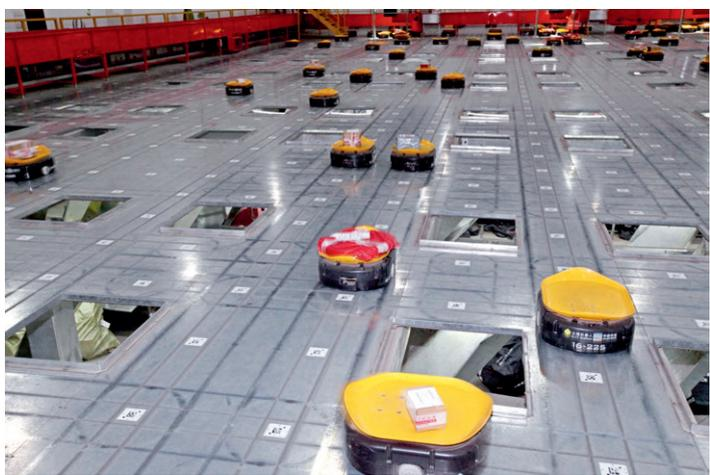
现代物流业已经广泛使用机器人替代人工分拣。分拣机器人配有测距感应系统，通过电脑后台控制，分拣准确率高、速度快。图为分拣机器人正在准确地把包裹送到指定投递口。
