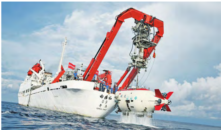
图 4-2-4 装有全球导航卫星系统的“向阳红 09”母船正在按预定地点投放“蛟龙号”
