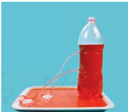
图9.2-1 液体从容器侧壁的孔中喷出
