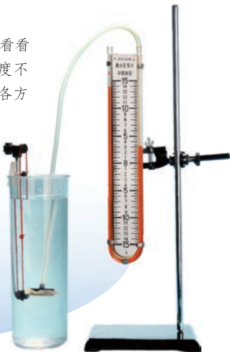
图9.2-2 同一深度液体向各个方向的压强是否相等？
