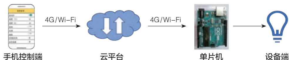
图4-3 室内智能灯光控制系统示意图
