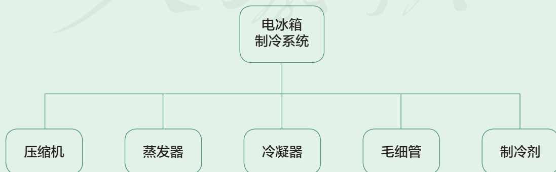
图3-3 电冰箱制冷系统构成
