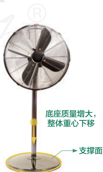
图1-23 落地电风扇重心与支撑面示意图
