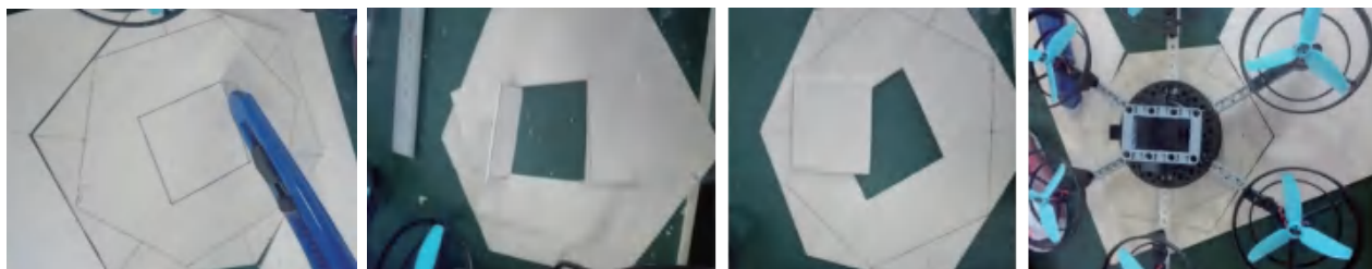
图2-53 设计制作吊舱并安装
