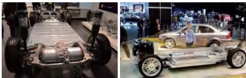
图2-11 新能源汽车的基本结构
