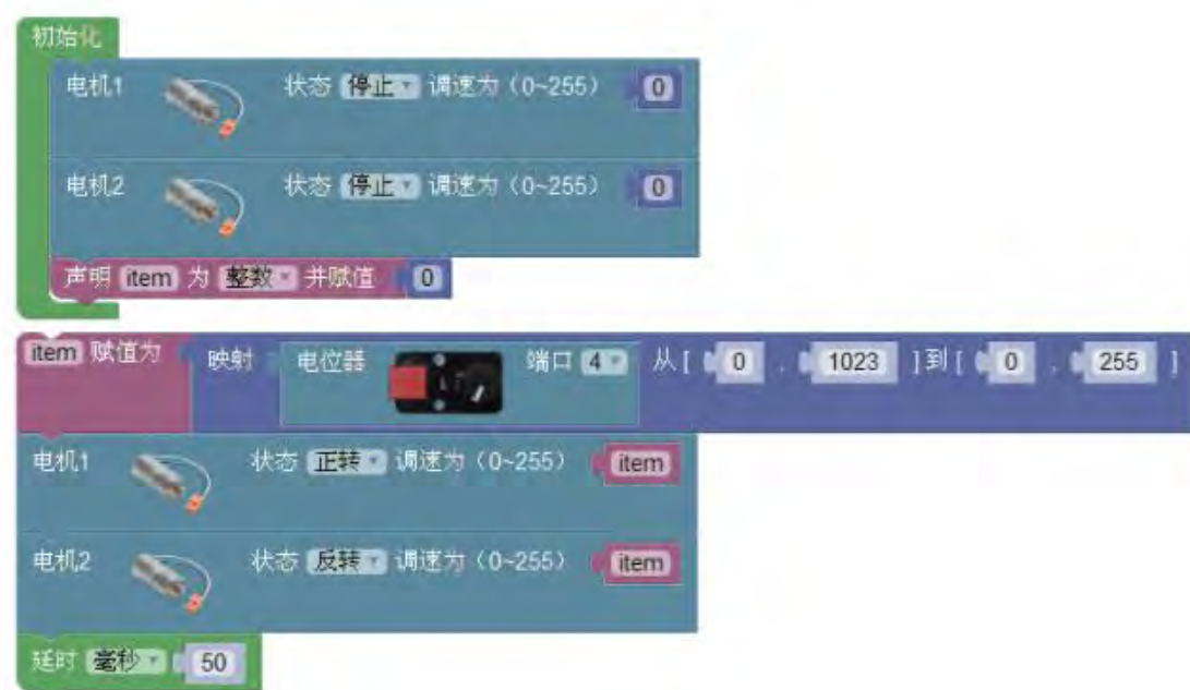
图2-25 小车加速与减速的图形化编程代码
