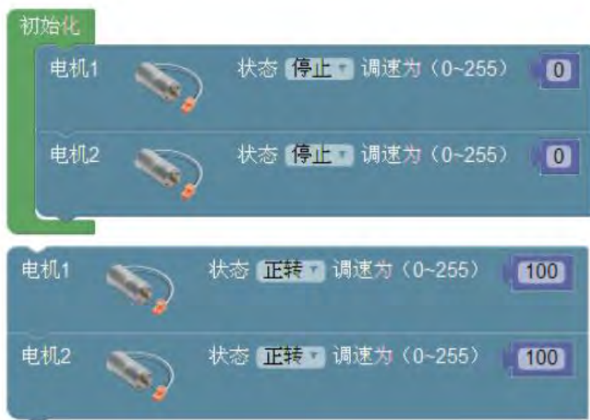
图2-21 小车启动和停止的图形化编程代码
