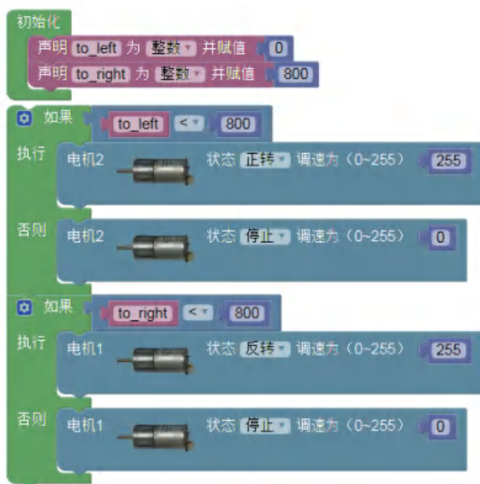
图2-27 小车转向控制的图形化编程代码
