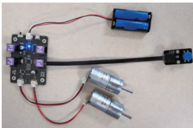
图2-22 按键控制小车前进与后退的应用系统
