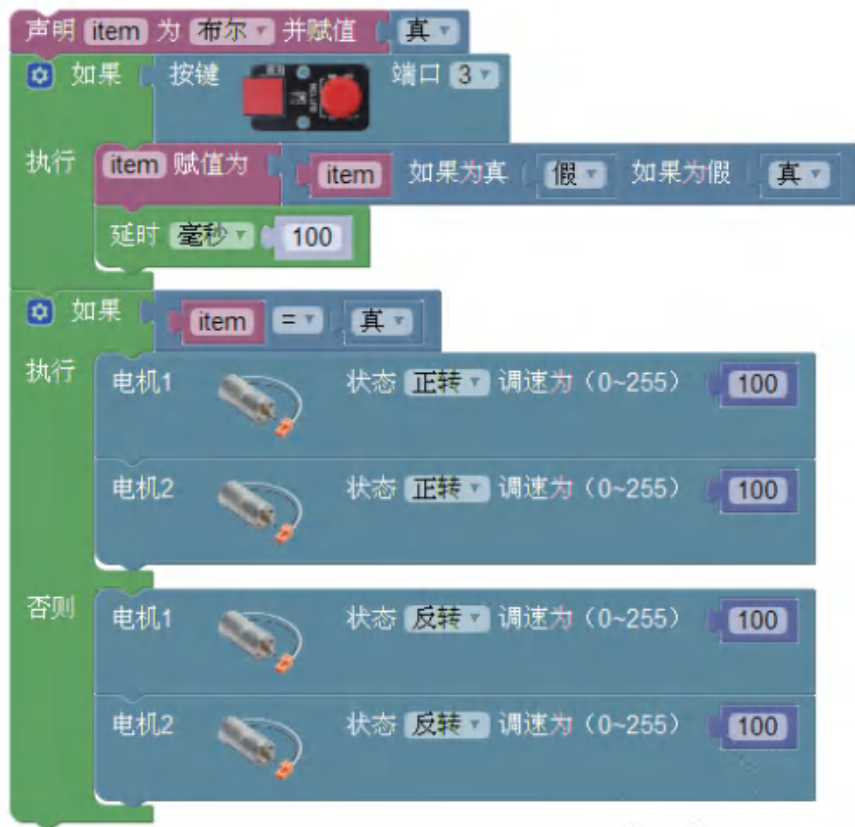
图2-23 小车前进与后退的图形化编程代码
