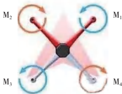
图2-46 四旋翼飞行器螺旋桨旋转方式
