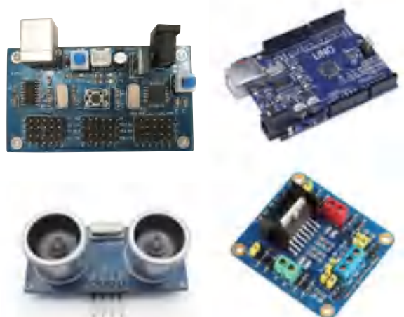
图1-14 Arduino和超声测距模块、电机模块
